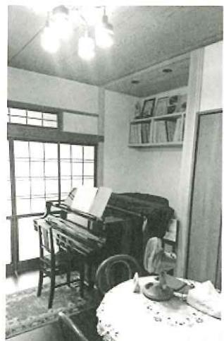
6帖の和室と洗面室の改修を行いました。グランドピアノを6帖の和室に動かされたいとのことから、床をフロア仕上げにし、押入れ部分を解体して、ピアノスペースを設けました。お客様がご用意されたシャンデリア風の照明も合わせ、オシャレな空間となりました。洗面室は、収納が少なくお困りだったので、収納力が高い洗面化粧台にすることで解決。腰壁のタイル部分はクロス仕上げにし、化粧台側面にはホーローパネルを取付けました。窓がなくなり光が取れなくなった部分は、洗面室の照明を変えることで明るさを補いました。
