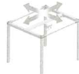
面移動できるタイプのリフトは移動範囲が広く、縦横無尽に移動が可能
